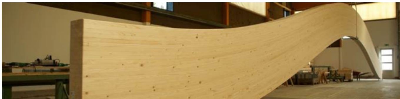
Limtræ er det samme som CLT, blot som søjle- og bjælkekonstruktion. CLT er blot hele plader til væg, gulv og tag. Foto: Flexwood-bjælke til Hellerup Gymnasium.
